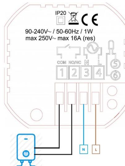
Zapojení s bezpotenciálovým kontaktem (Dry Contact) pro ovládání kotlů – elektrických, plynových, na pevná paliva a tepelných čerpadel. Na kontaktech 1 a 2 (NO a COM) není žádné napětí, pouze dojde k sepnutí těchto kontaktů. Pro zařízení je to signálem, že má topit.
