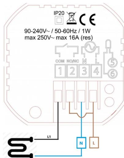
Zapojení pro napěťové spínání – pro elektrické vytápění, vodní podlahové topení, elektrické topení, elektrické konvektory, infrazářiče apod. - spojte kontakty 2 a 4 bypasssem a na spotřebič připojte kontakt 1 (spínaná fáze do 16A) a dále na spotřebič připojte nulový vodič (a připojte napájení na 3 a 4).
